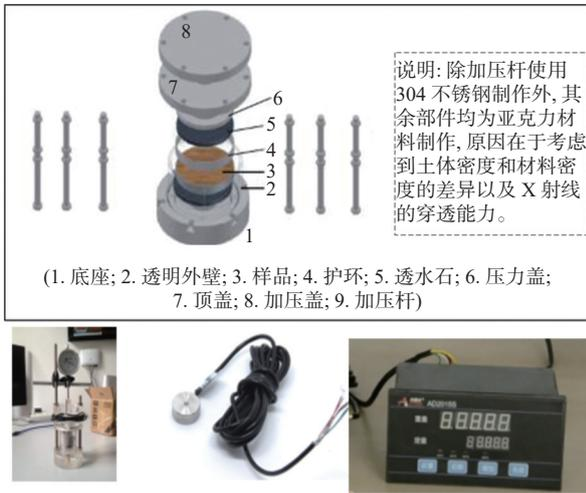
图 13 研发的黏性土压密测试仪器展示图
