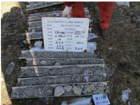
图 6 波里拉组灰岩的溶蚀破碎带
