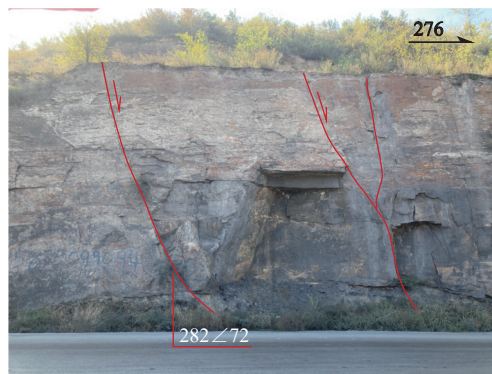
图4 中奥陶世厚层灰岩中发育正断层野外照片
