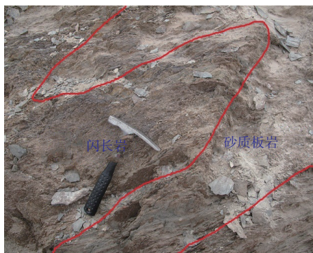
图 4 闪长岩与砂质板岩宏观接触关系图
