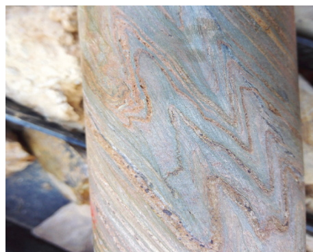
图 5 砂质板岩中不对称剪切褶皱构造图
