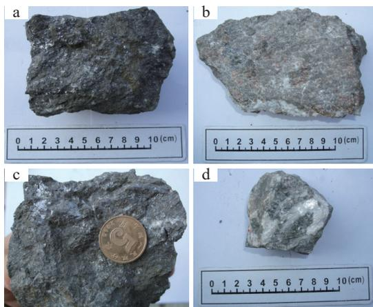
a. 块状铅锌矿石; b. 边部稀疏浸染状矿石与矿化蚀变围岩;
