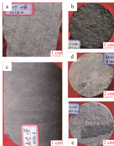
a. 含砾粗砂岩相, 发育交错层理, 3 528.2 m, 苏 59 井; b. 灰黑色泥岩相, 见碳质纹层, 3 608.4 m, 苏 59-13-51B 井; c. 沙纹层泥质粉砂岩相, 可见明显的沙纹层理构造, 3 532.6 m, 苏 59 井; d. 含砾粗砂岩相, 3 531.05 m, 苏 59-13-51B 井; e. 细-中砂岩相, 断面可见碳质, 3 548.74 m, 苏 59-13-51B 井
