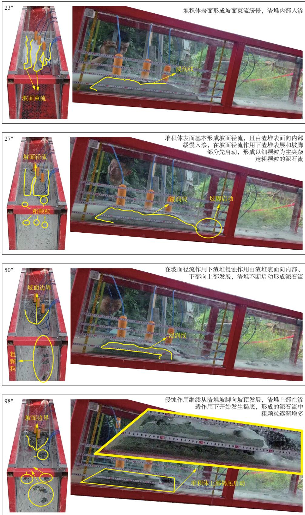
图9 D24组次试验泥石流启动过程
