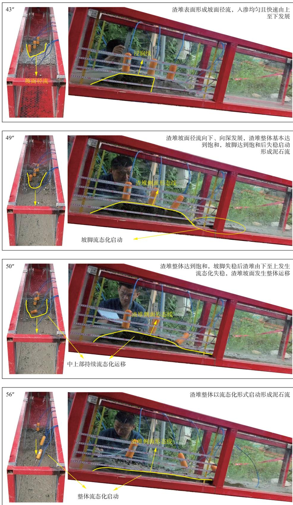
图10 D07组次试验泥石流启动过程
