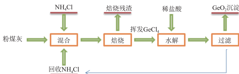
图3 氯化焙烧法从粉煤灰中提锗生产流程 [7]
