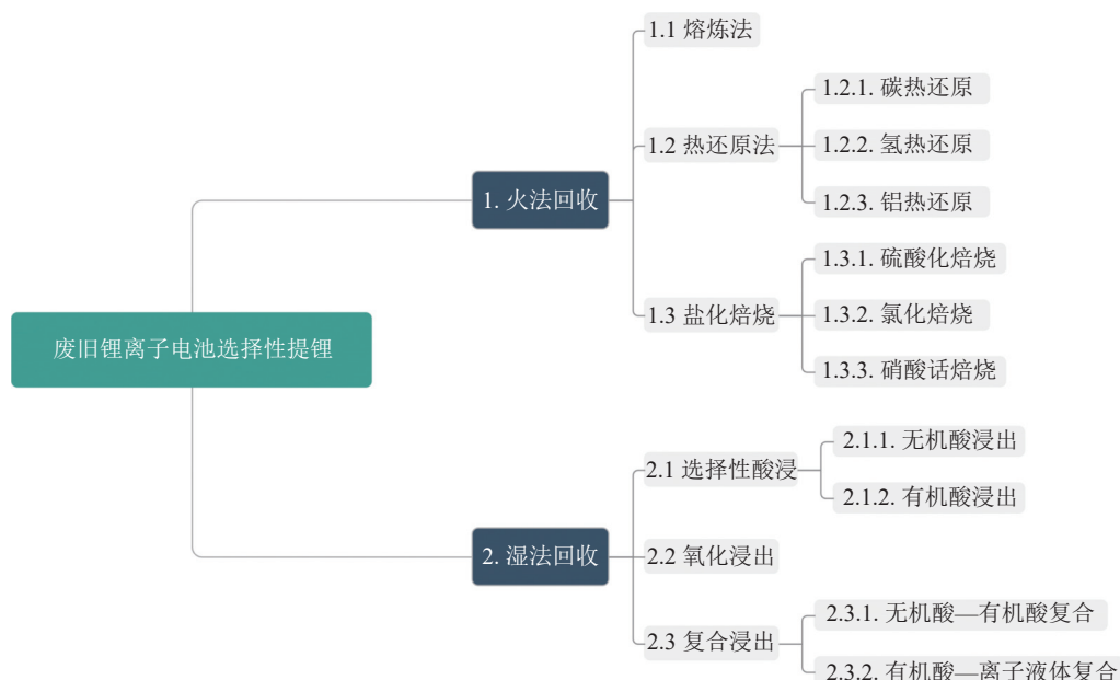
图1 废旧锂离子电池选择性提锂方法
