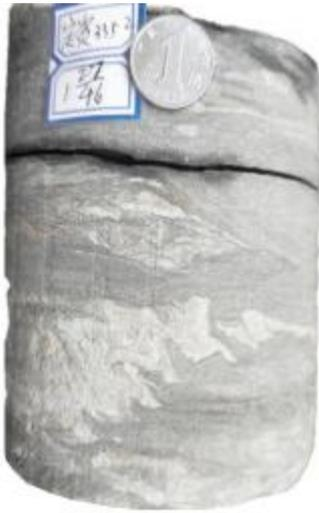
图5 DT3522井延7油层组液化砂岩脉
