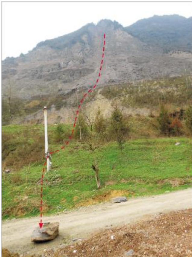
图 4 危岩体落石(K15)运动轨迹线
