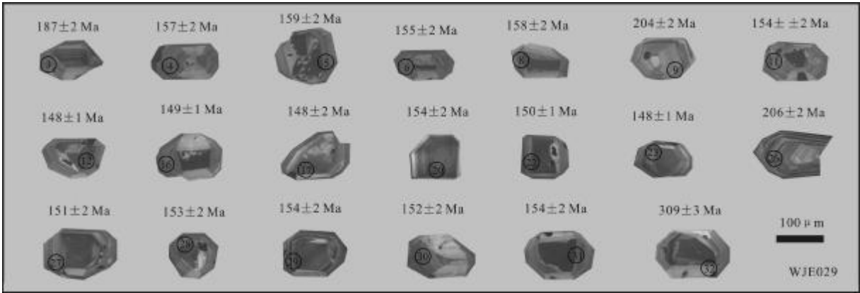
图 2 流纹质岩屑晶屑弱熔结凝灰岩部分锆石阴极发光图像 Fig. 2 CL images of zircons in rhyolitic lithic crystal weakly welded tuff
