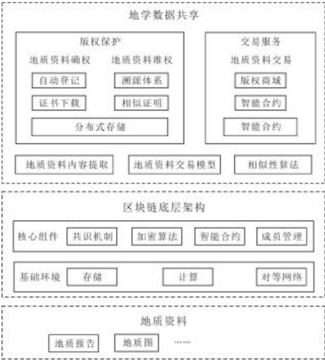
图 2 基于区块链的地质数据共享系统架构
