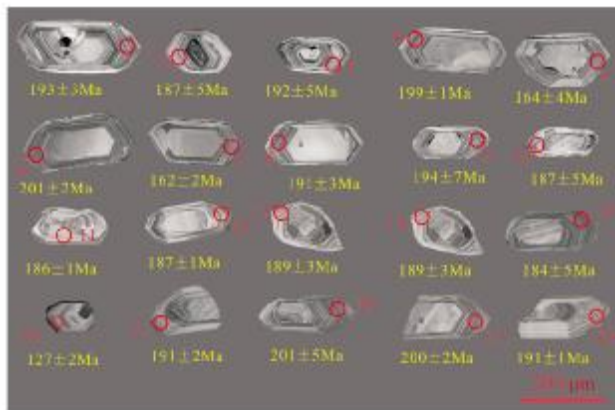
图5 PM04-28 号样品锆石 U-Pb 同位素年龄测定结果谐和图和阴极发光图
