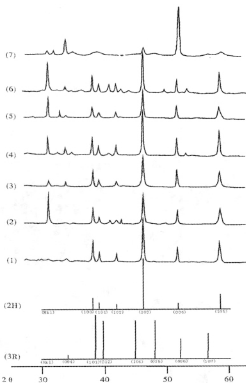
图2 坪地钼矿辉钼矿的X光衍射图谱与标准辉钼矿多型的峰型的对比
