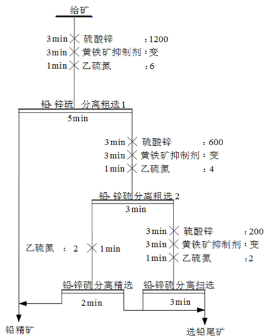
图3 黄铁矿抑制剂对比试验流程
