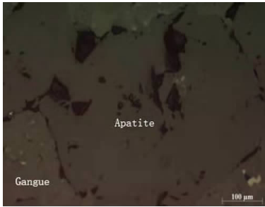
图 1 选铁尾矿 SEM 分析 Fig. 1 SEM analysis of iron tailings
