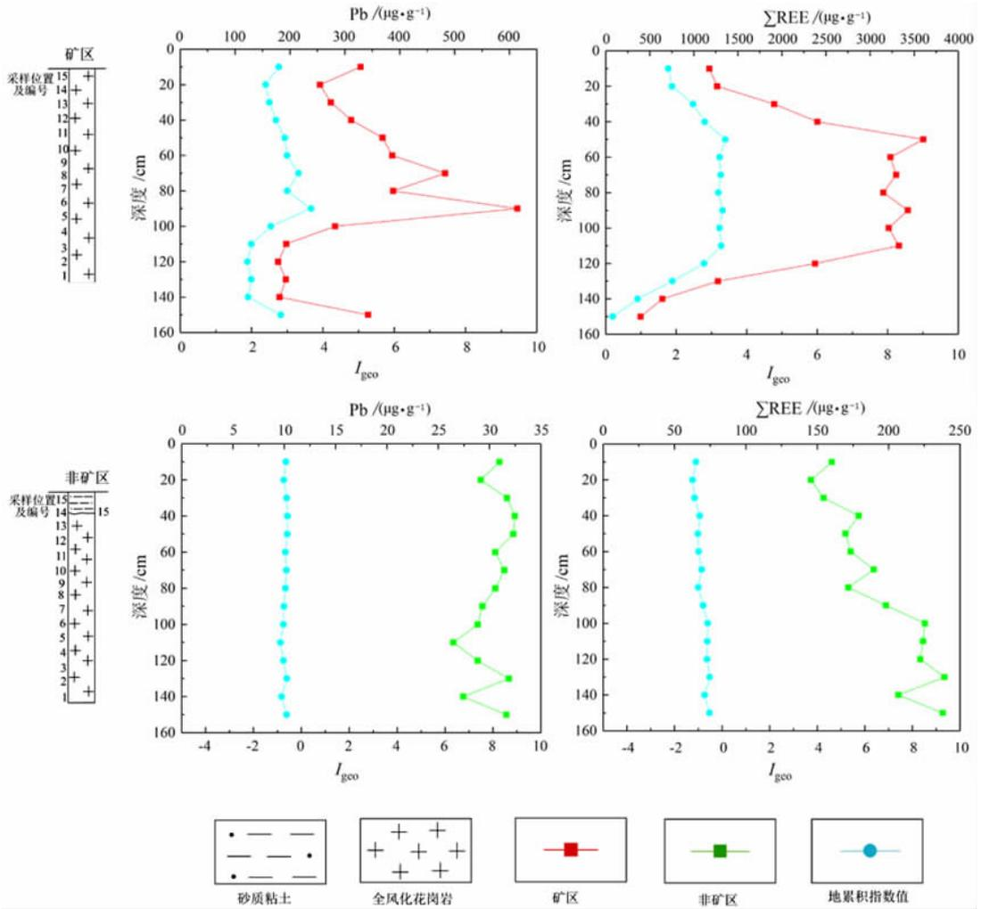
图 10 Pb 和  $\Sigma$ REE 在矿区及非矿区土壤剖面的岩性和含量对比图
