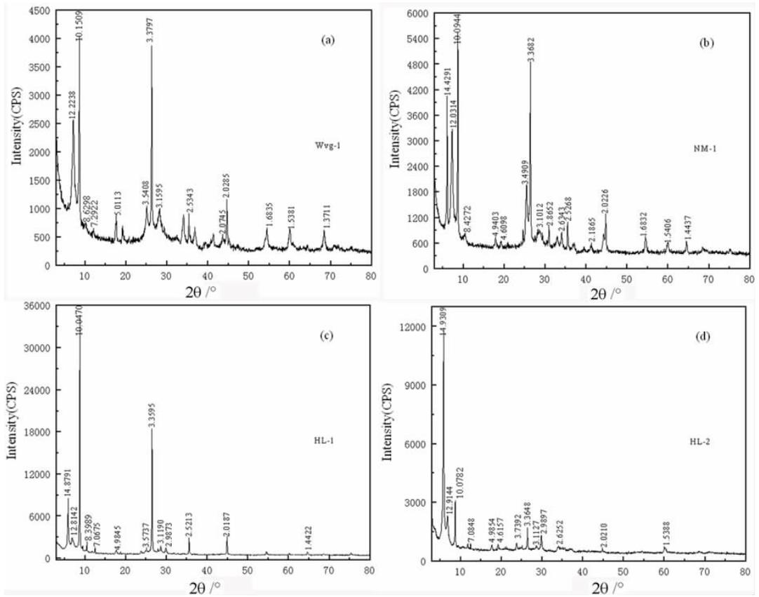
图 1 不同产地工业蛭石样品的 XRD 图
