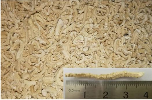
图 8 高膨胀率膨胀蛭石的照片
