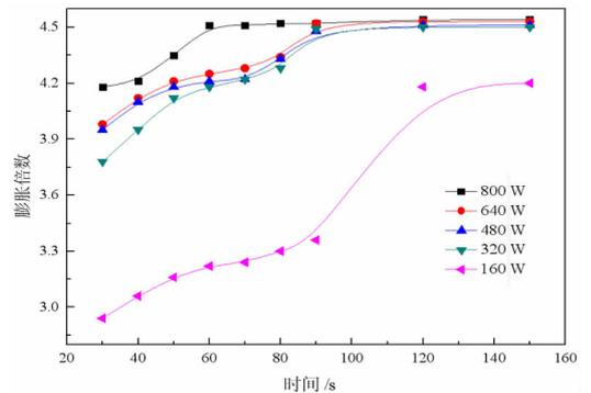
图3 微波加热法膨胀倍数与微波功率和时间的关系
