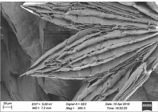
图 9 高膨胀率膨胀蛭石的 SEM 照片
