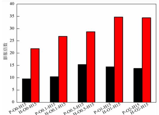
图 6 有机酸添加量对样品膨胀率的影响
