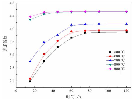
图2 灼烧加热法膨胀倍数与加热温度和时间的关系
