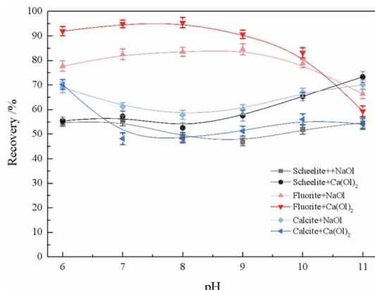
图 4 Ca(OL)<sub>2</sub> 胶体与油酸钠作捕收剂,三种含钙矿物浮选回收率与 pH 的关系( $C_{Ca(OL)_2} = C_{HOL} = 1 \times 10^{-3}$  mol/L)
