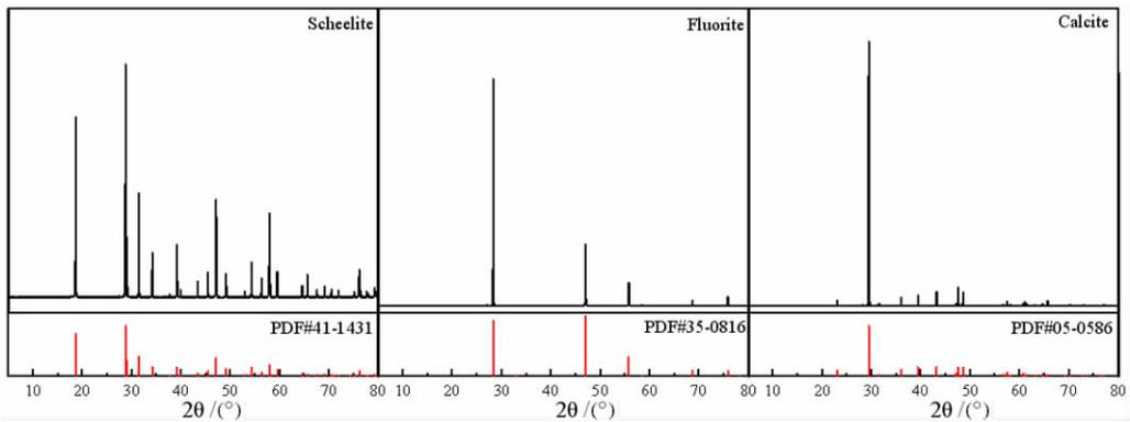
图1 白钨矿、萤石和方解石单矿物X射线衍射分析图
