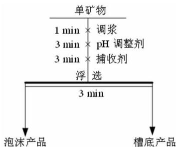
图2 单矿物浮选试验流程
