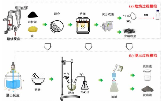
图 5 反应流程示意图
