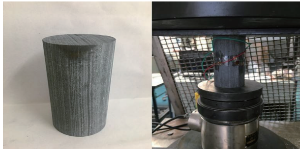
图 3 赤铁矿石单轴压缩试样图 Fig. 3 Uniaxial compression sample of hematite ore
