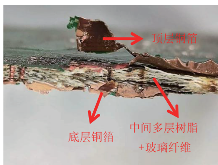
图1 典型废旧电路板的断面
