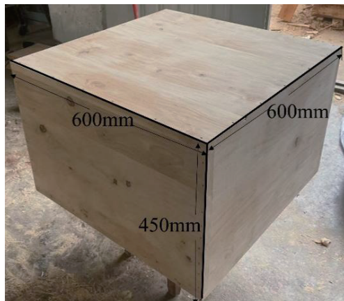
图 3 木制浮箱式点柱实物
