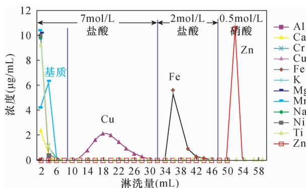
图 1 Fe 与基质的化学分离淋洗曲线<sup>[33]</sup>
