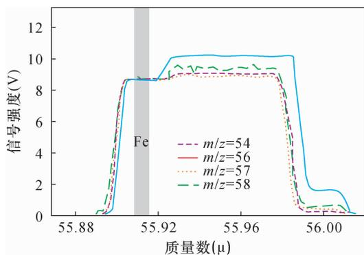
图2 高分辨率模式下铁同位素与干扰峰的谱峰<sup>[33]</sup>
