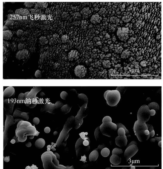
图3 飞秒激光和纳秒激光剥蚀出气溶胶的粒径对比<sup>[91]</sup>
