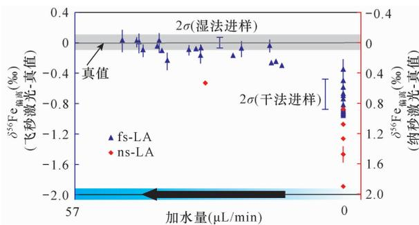
图4 水蒸汽对飞秒激光和纳秒激光基质效应的抑制对比<sup>[93]</sup>
