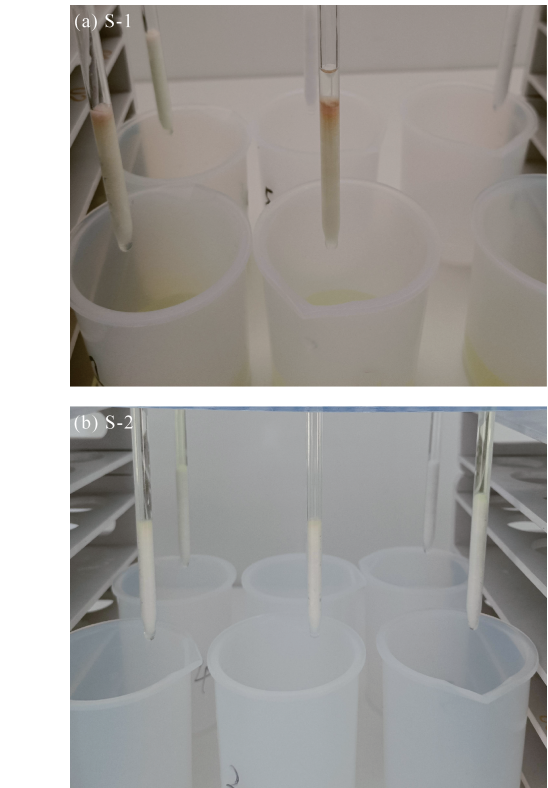
a—巯基棉质量为 0.15g(S - 1 组)发生饱和,显现红色; b—巯基棉质量为 0.2g(S - 2 组)未发生饱和,无显色。
