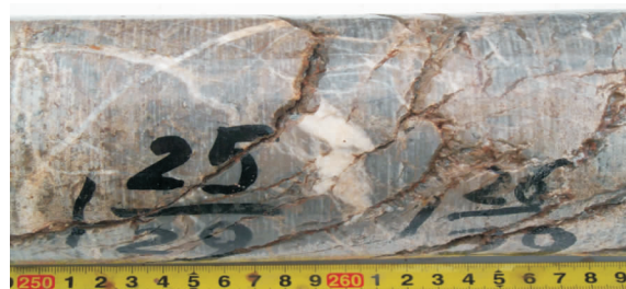
图 7 N5 井三叠系青龙组碳酸盐岩裂隙发育岩心照片
