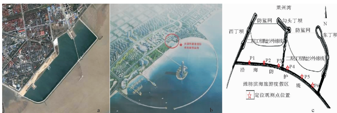
a 上海金山封闭式围堰;b 天津东疆半封闭式弧形围堰;c 潍坊央子的鱼尾式丁坝群护沙
