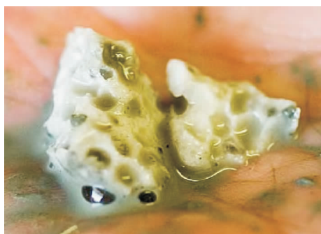
图 4 马克兰增生楔水深 1 000 m 的 2 号羽状流站位的水合物样品(具气泡结构)(据文献[4])
