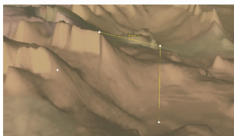
图 15 海底地形空间分析——等高线分析与立体量高 Fig. 15 Seabed topographic analysis-measurement of bathymetry and topographic high
