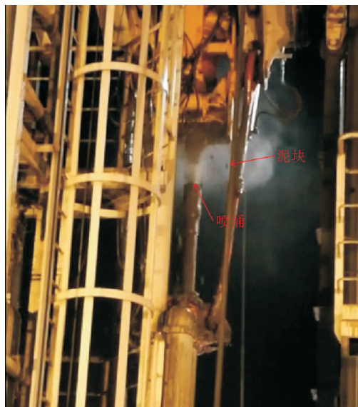
图 7 钻井时泥浆喷涌情况
