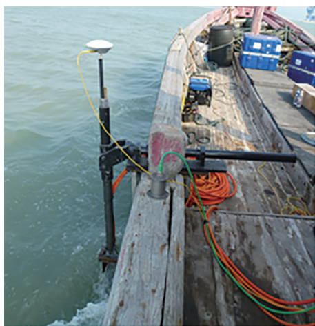
图 3 SES-2000 换能器实测安装位置图
