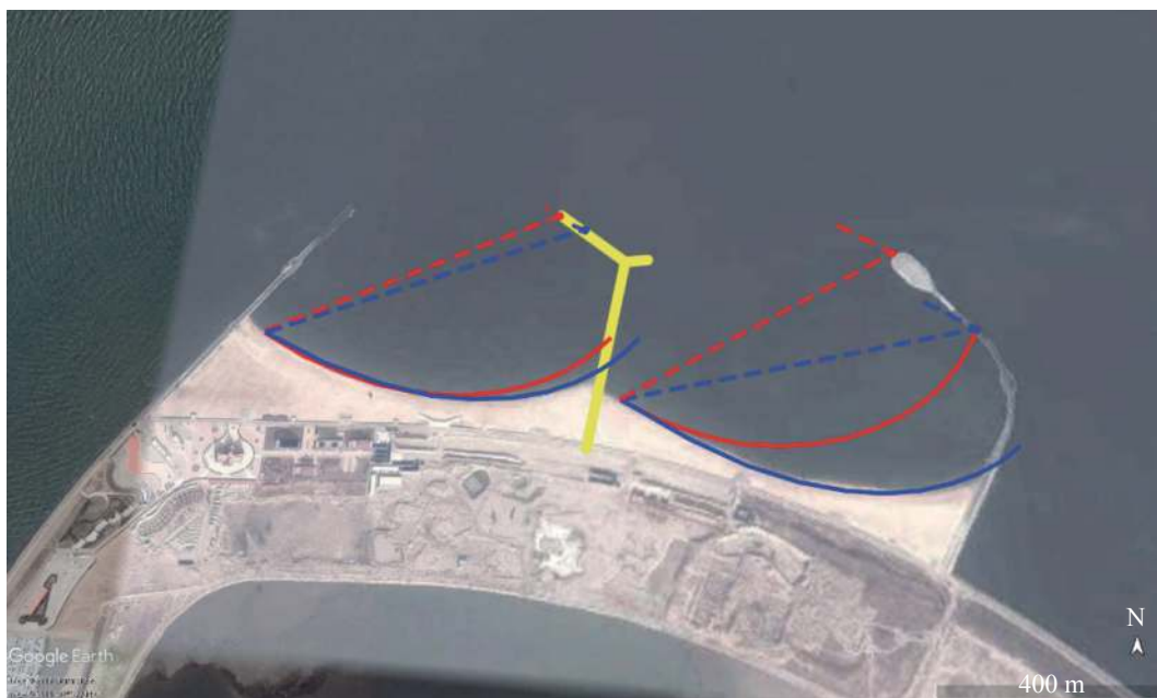
图 7 现有丁坝设计的评估(底图:谷歌地图)
