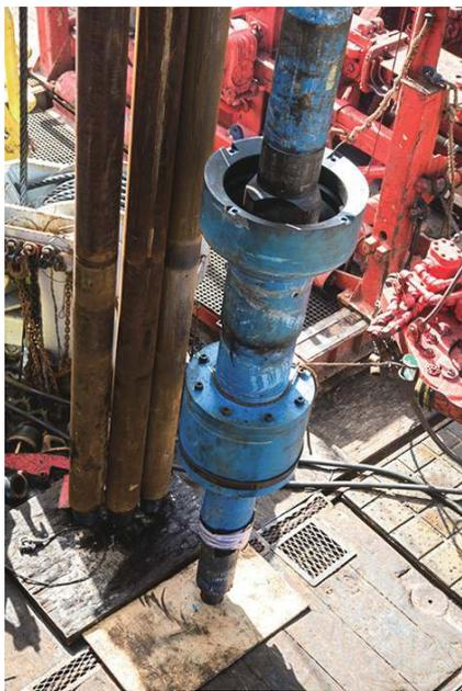
图8 套管送入工具
