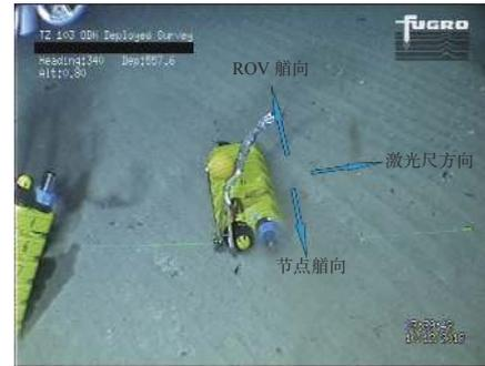
图 6 ROV 进行节点布设
