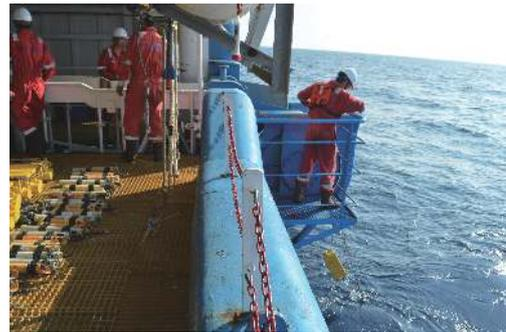
图 2 船载 OBN 布设示意图
