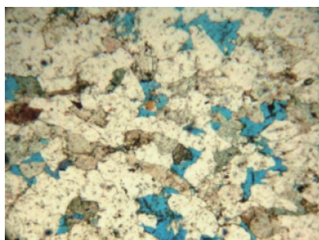
长石石英砂岩, 颗粒间溶蚀孔隙, 二叠系龙潭组, 巢湖地区, 单偏光, \times 40
