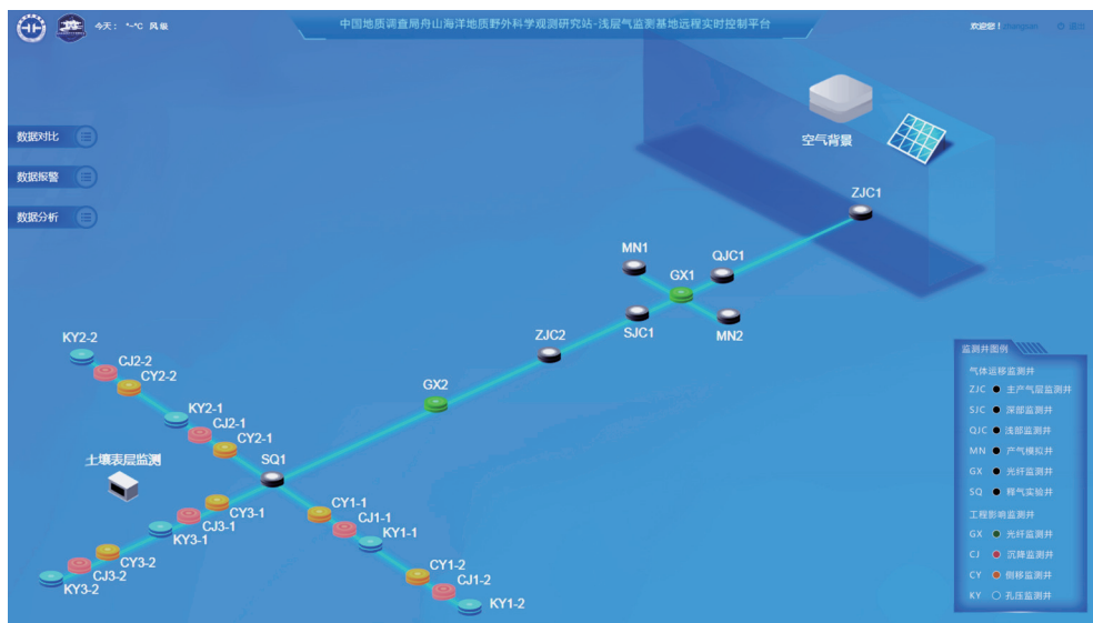
图 4 舟山浅层气监测系统远程实时控制平台界面
