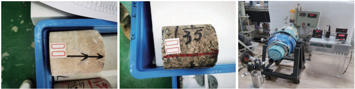
图 2 全直径岩芯与 SCAR-II 型高温高压全直径岩芯分析仪
