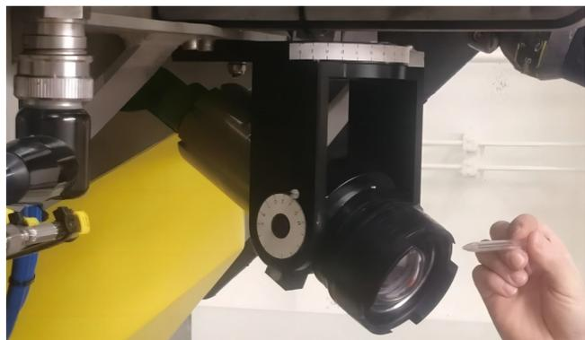
图 2 Fugro 机器视觉 3D 摄像机
