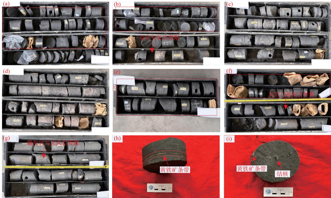
(a)4 330.3~4 335.03 m, 黑色页岩和灰岩互层; (b)4 335.03~4 339.03 m, 页岩与灰岩界限; (c)4 339.03~4 342.46 m; (d)4 342.46~4 346 m; (e)4 363~4 365.46 m; (f)4 365.46~4 369.65 m, 黑色页岩与凝灰岩界限; (g)4 369.65~4 373.63 m, 凝灰岩与玄武岩界限; (h)4 334.68 m, 黄铁矿条带发育; (i)4 336.8 m, 可见黄铁矿和结核
