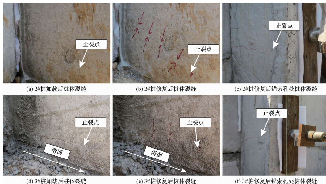
图 8 抗滑桩破坏形迹
