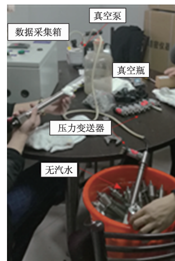
图 8 负压传感器抽气时的连接
