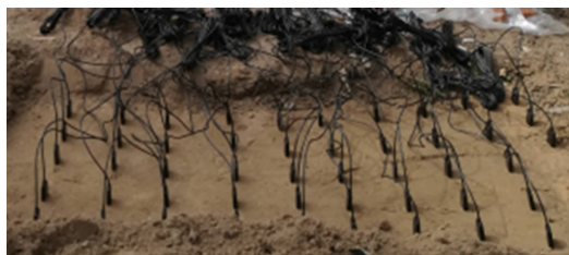
图 10 鉴定 5 TM 土壤水分、温度传感器
