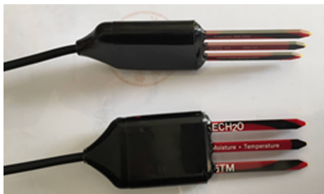
图 9 5 TM 土壤水分、温度传感器
