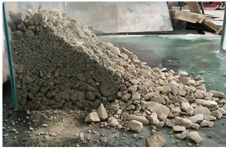
图6 现场休止角试验
