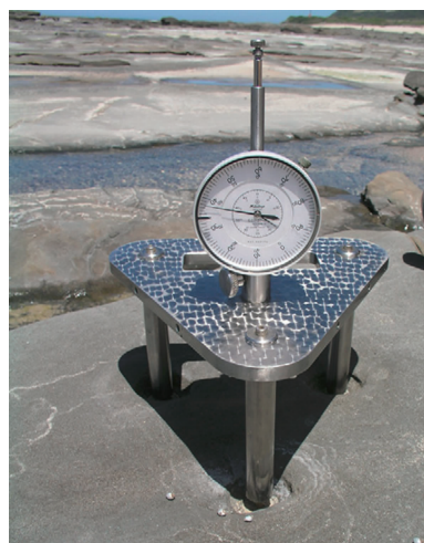
图6 测试现场的微侵蚀仪
