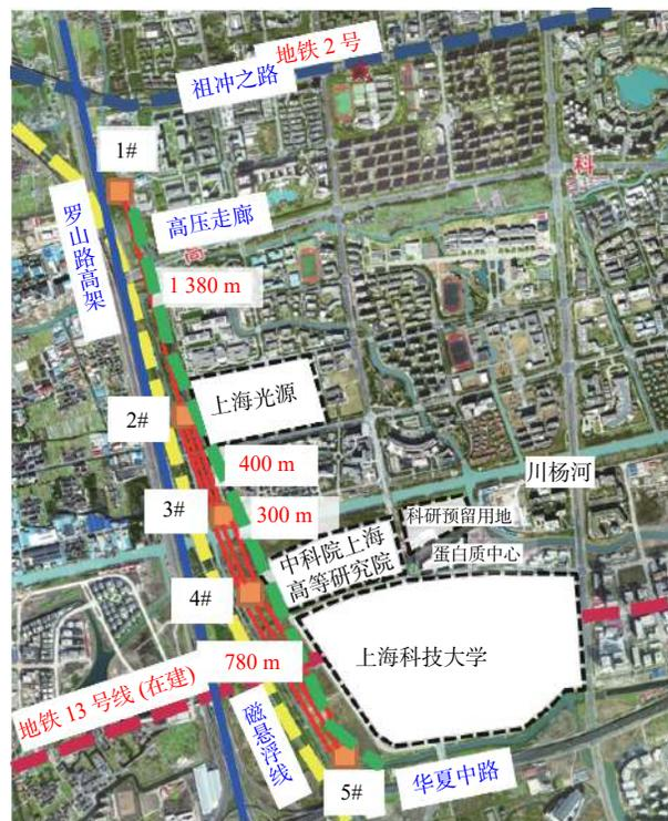
图 1 硬 X 射线平行盾构工程平面图
