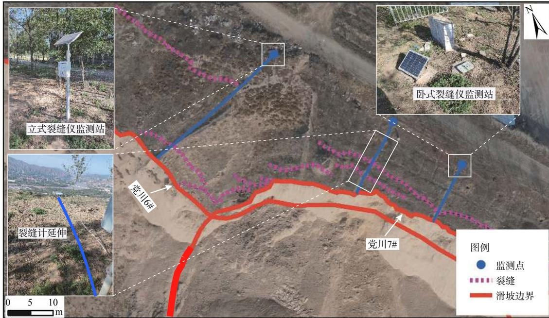
图2 滑坡监测点布设示意图
