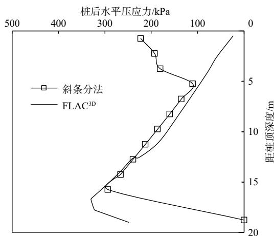
图 7 4 种设桩方案下前排桩受荷段推力分布曲线
