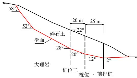
图 4 双排抗滑桩加固滑坡实例横截面图
