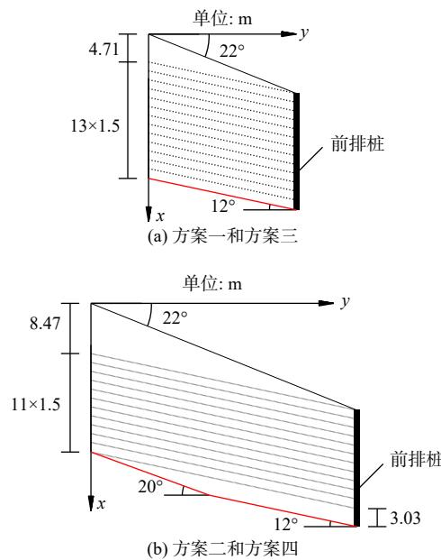
图 6 4 种设桩方案对应的条分模式
