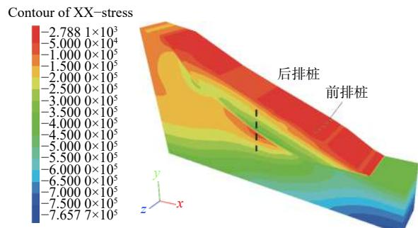
图 9 实例方案四加固坡体的水平应力分布云图
