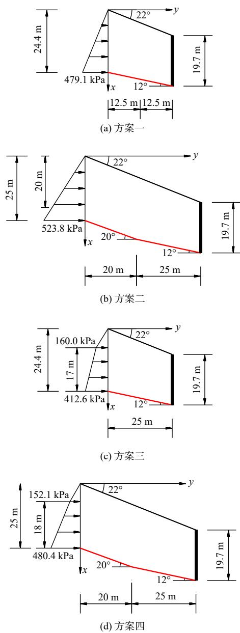
图 5 4 种设桩方案对应的排间滑体计算模型
