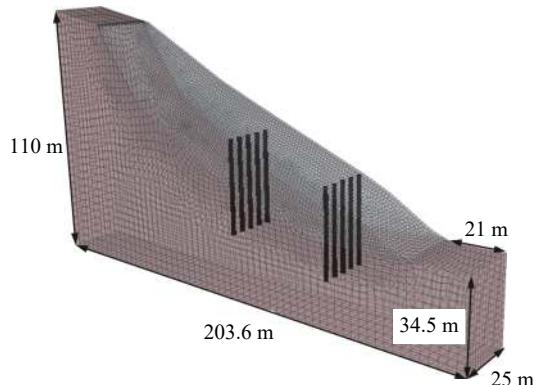
图 8 实例方案四的双排抗滑桩加固滑坡数值模型
