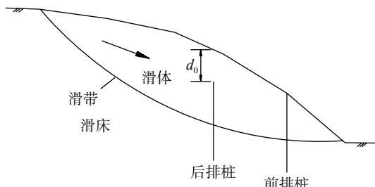
图1 双排桩加固滑坡横截面示意图
