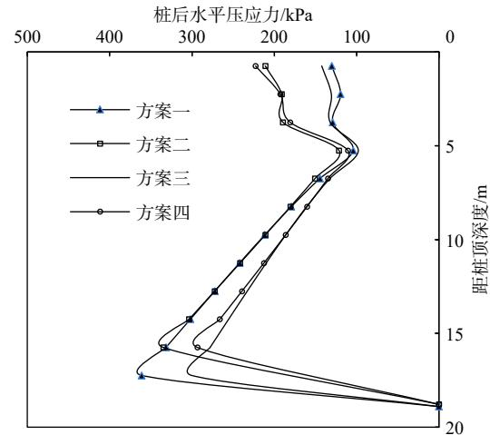
图 10 实例方案四时前排桩后侧推力分布模式对比
