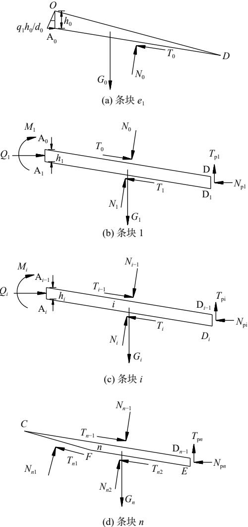
图 3 各典型斜条块受力分析模型
