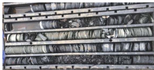
图 4 郭达山隧道钻孔饼状岩心发育特征
