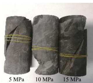
图 6 三轴压缩蠕变试验条件下试样破裂形态
