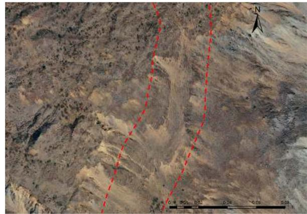
图9 滑源区北侧斜坡上裂缝带(影像:20191217无人机)
